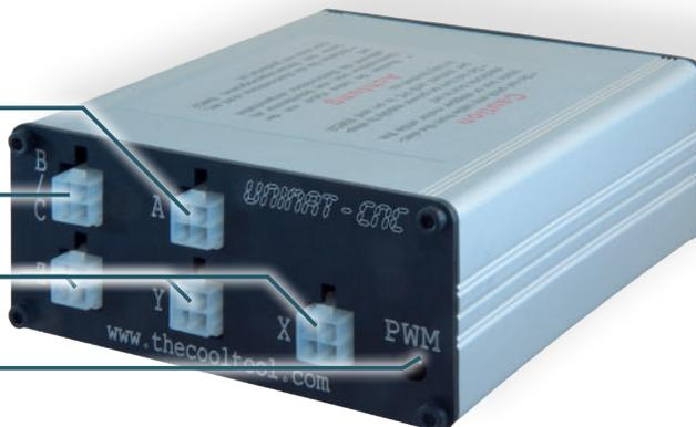
Sterownik CNC dostępny jest w dwóch opcjach: pełnej 5-cio osiowej (LIN-CONTR5) i ekonomicznej 3 osiowej (LIN-CONTR53). Standardowo dostarczany zapewnia sterowanie dla 2A silników krokowych. Na zamówienie dostępne wersje z możliwością sterowania silników do 5A.
